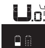
Ak sa na eBike s dvomi vloženými akumulátormi nabíjajú obidva akumulátory na bicykli, potom sa na displeji zobrazuje progres nabíjania obidvoch akumulátorov (na vyobrazení sa nabíja práve ľavý akumulátor). To, ktorý akumulátor sa práve nabija, môžete zistiť podľa blikajúcej indikácie na akumulátore.
